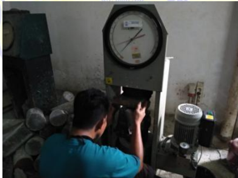
PENGUJIAN KUAT TARIK BELAH BETON
