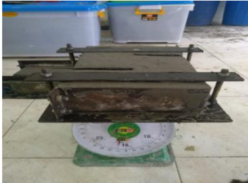
PENIMBANGAN CETAKAN + BETON SEGAR
