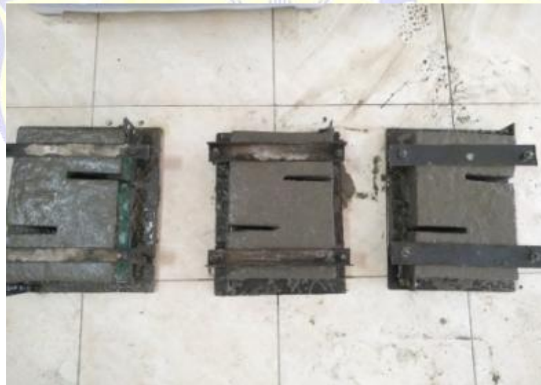
BETON SEGAR SESUDAH DI TIMBANG
