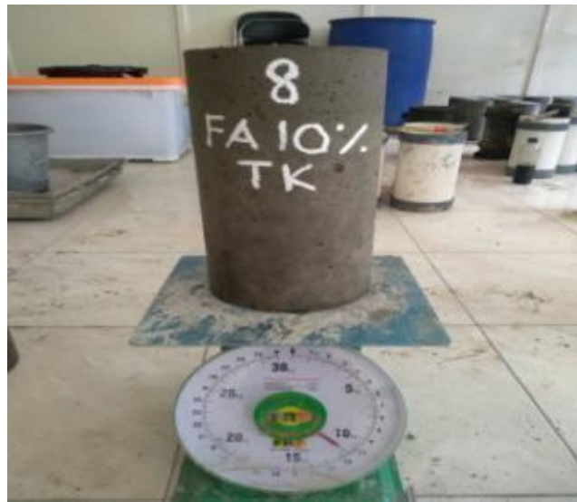
PENIMBANGAN BENDA UJI SILINDER BETON KERING
