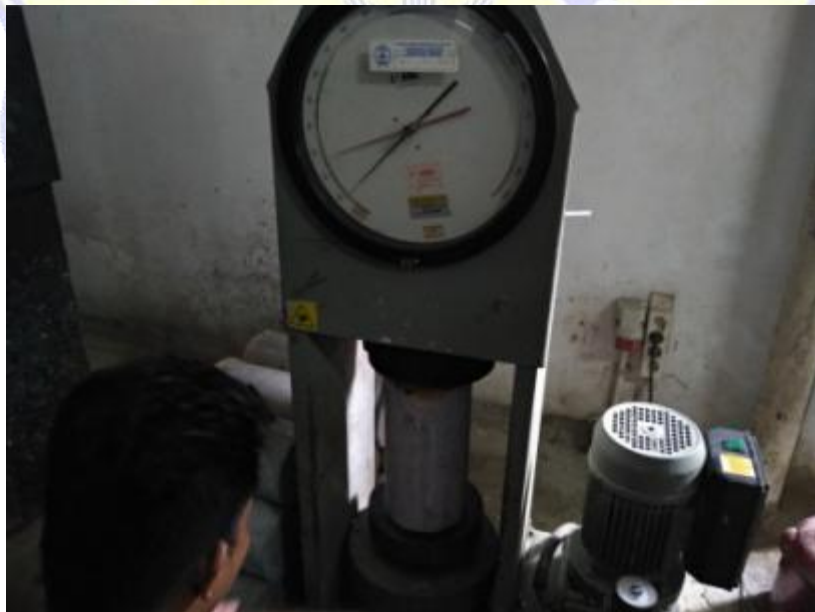
PENGUJIAN KUAT TEKAN BETON
