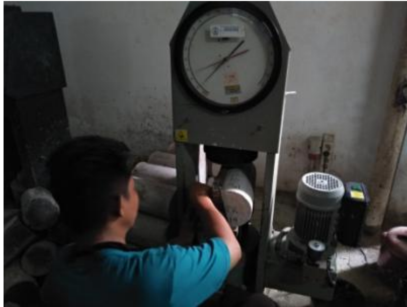
PENGUJIAN KUAT TARIK BELAH BETON
