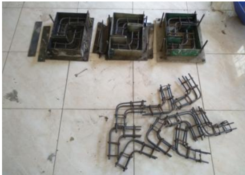
PERSIAPAN CETAKAN DAN TULANGAN DOUBLE-L
