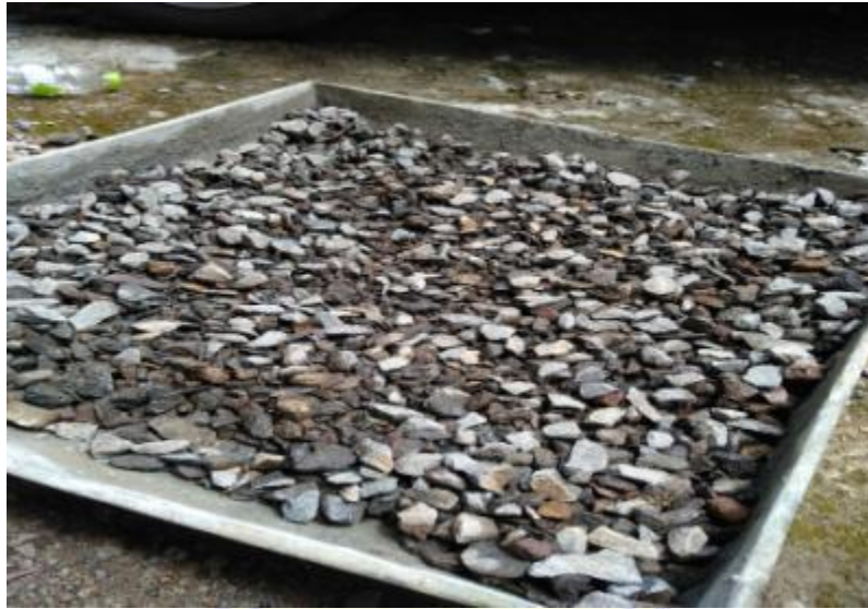
PENGERINGAN AGREGAT KASAR
