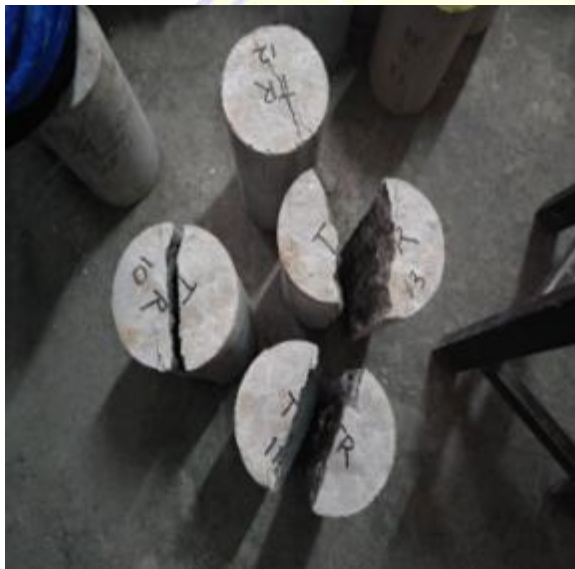
KERUNTUHAN BENDA UJI SILINDER DAN DOUBLE-L SETELAH PEMBERIAN BEBAN MAKSIMUM
