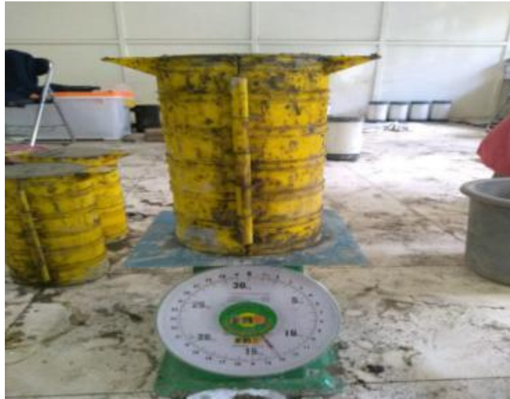
PENIMBANGAN CETAKAN + BETON SEGAR
