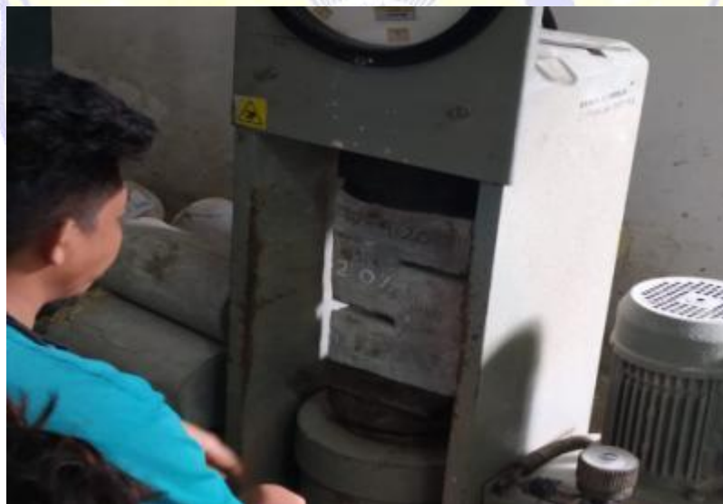
PENGUJIAN KUAT GESER BETON
