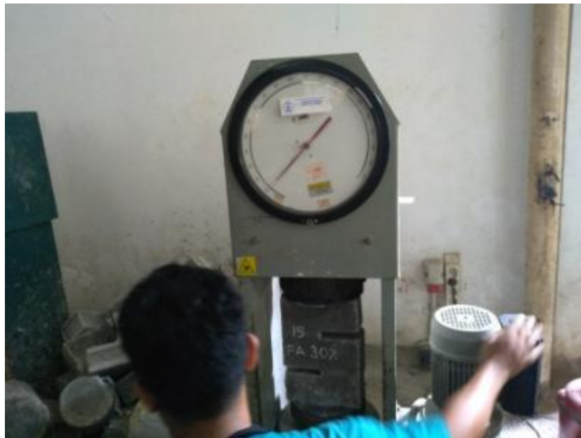
PENGUJIAN KUAT GESER BETON
