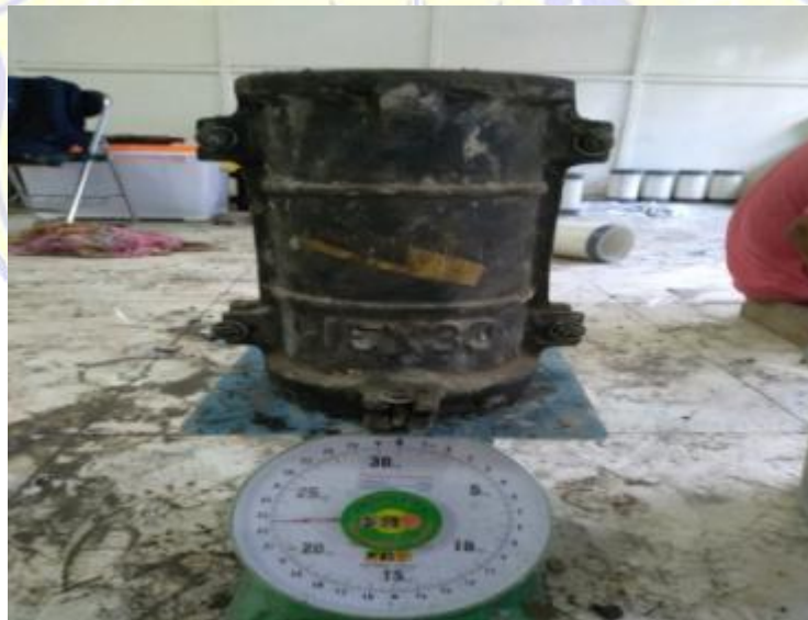
PENIMBANGAN CETAKAN + BETON SEGAR
