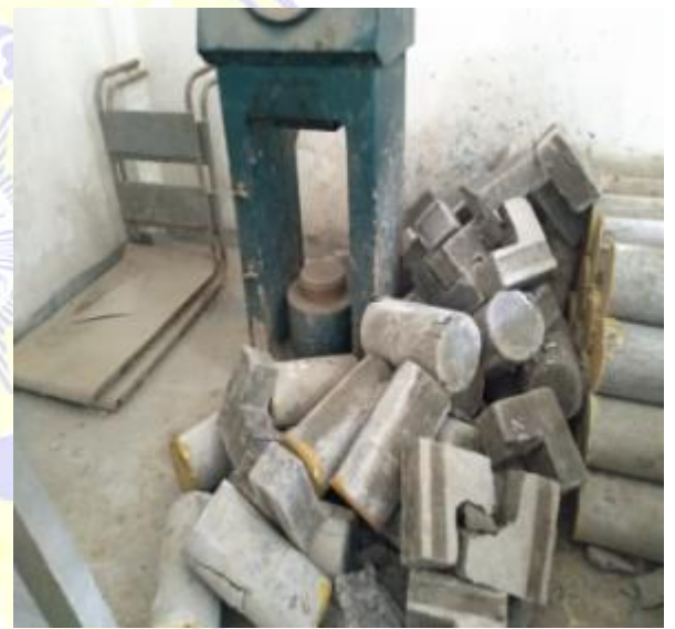
KERUNTUHAN BENDA UJI SILINDER DAN DOUBLE-L SETELAH PEMBERIAN BEBAN MAKSIMUM
