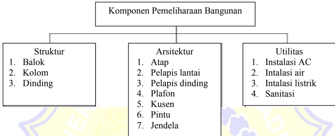
Gambar 2.2 Klasifikasi pekerjaan pemeliharaan bangunan
