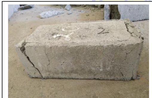
Gambar 21. Kondisi benda uji setelah uji tekan
