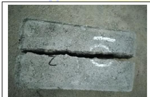
Gambar 23. Kondisi benda uji setelah uji tarik
