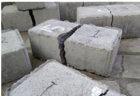
Gambar 25. Kondisi benda uji setelah uji impact
