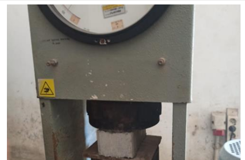
Gambar 20. Pengujian kuat tekan
