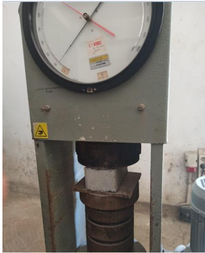
Gambar 3.2 Pengujian Kuat Tekan Paving Block
