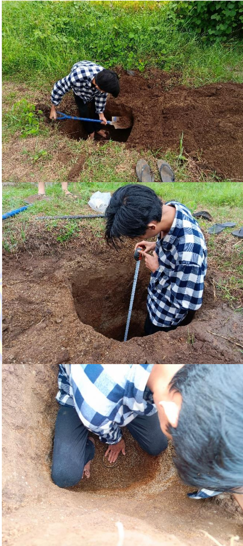
Proses pengambilan sampel dengan metode lubang uji ( test-pit ) Pada Desa Sokong Kecamatan Tanjung Kabupaten Lombok Utara
