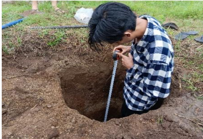
Gambar 3.2 Lubang Uji ( Test-Pit ) (Sumber : Dokumentasi Pribadi, 2024)
