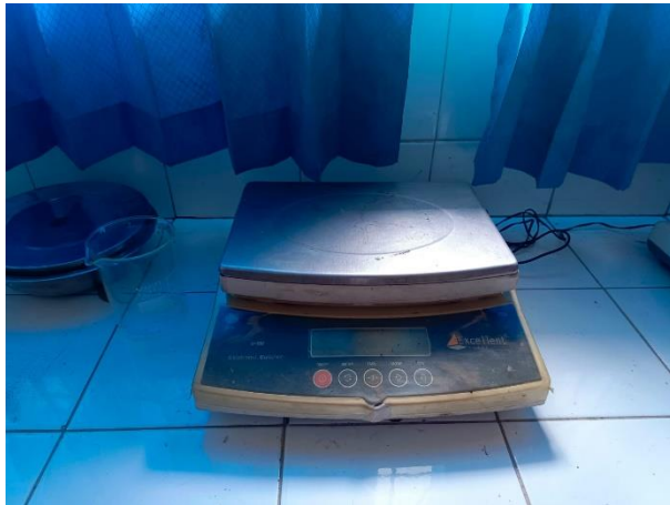
Gambar 3.7 Timbangan ketelitian 0,1 gram (Sumber : Dokumentasi Pribadi, 2024)
