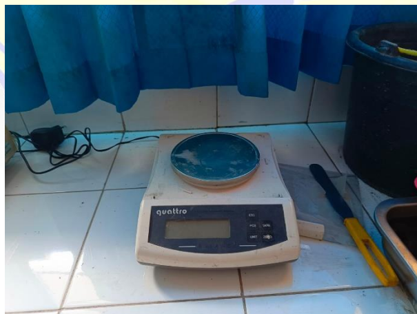
Gambar 3.6 Timbangan ketelitian 0,01 gram (Sumber : Dokumentasi Pribadi, 2024)
