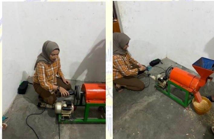
Proses Pengukuran Kecepatan Putaran Mesin Dan Daya Aliran Listrik
