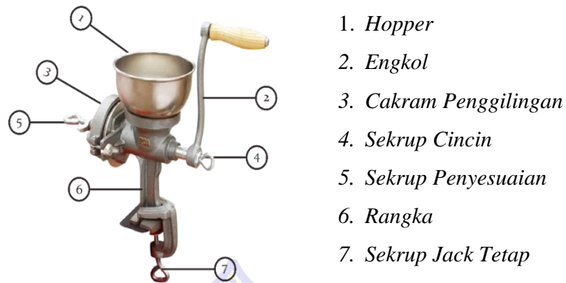
Gambar 3. Alat Pemecah Biji Jagung Tradisional
