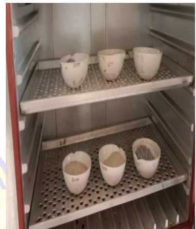
Gambar 3. Pemanasan silika gel dan zeolit
