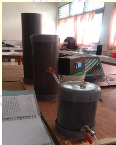
Gambar 5. Alat pemurnian biogas
