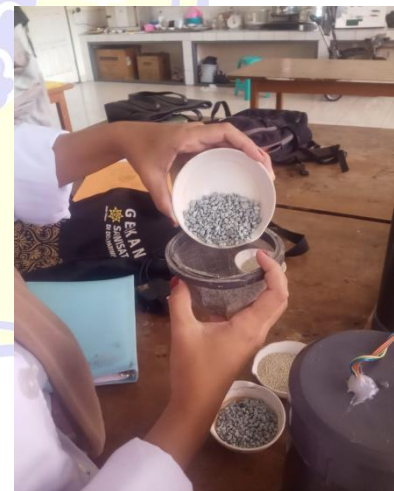
Gambar 6. Proses pemindahan bahan dari cawan ke saringan
