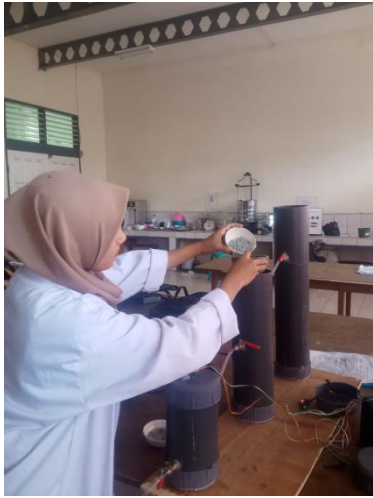
Gambar 7. Proses memasukan saringan berisi bahan kedalam alat pemurnian
