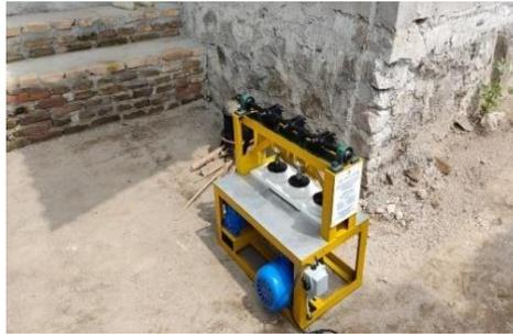
Gambar: 4. Mesin pemipih emping dengan kapasitas 2 kg/jam
