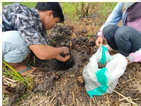
Gambar 3.2 Pengambilan Sampel Tanah Lempung (Sumber: Dokumentasi, 2023)
