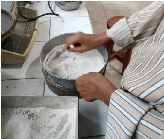
Gambar 3.3 Proses Pengayakan Limbah Gypsum (Sumber: Dokumentasi, 2023)
