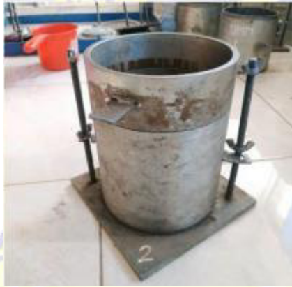
Gambar 3.15 Cetakan atau Mold (Sumber: Dokumentasi, 2023)
