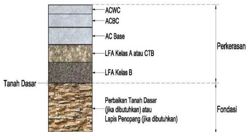
Gambar 2.6. Tipikal Skema Dari Lapisan Struktur Perkerasan.
