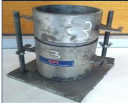
**Gambar 3.9** Alat Cetakan Uji Pematatan Standar Proctor
