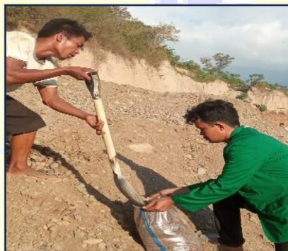
**Gambar 3.2** Pengambilan Sampel Agregat Base Kelas B
