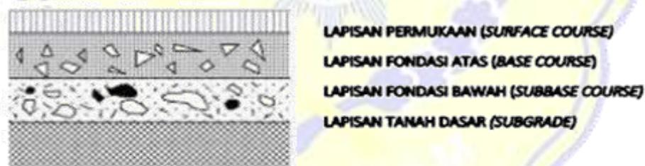
Gambar 2.1 Komponen Struktur Perkerasan Lentur
