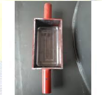
Gambar 3.9 Cetakan Paving Block
