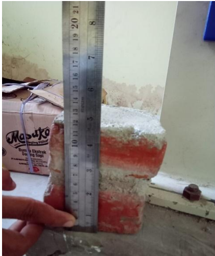
Pengukuran benda uji tekan
