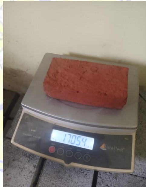
penimbangan bata jenuh air
