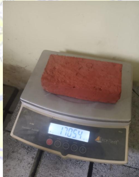
penimbangan bata jenuh air
