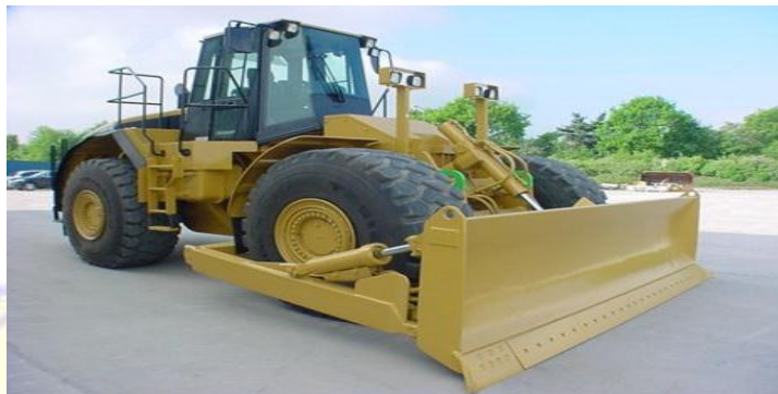
Gambar 2.2 Bulldozer dengan penggerak Wheel Tractor Dozer
