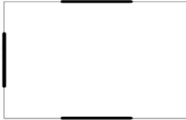
Gambar 2. 19 Dinding tunggal pada tiap sisi bangunan
