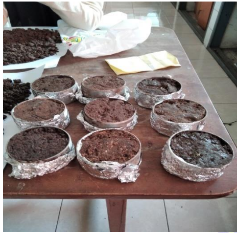
Pengukuran Berat Volume Tanah
