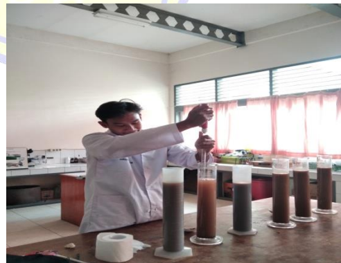
Pengukuran tekstur tanah
