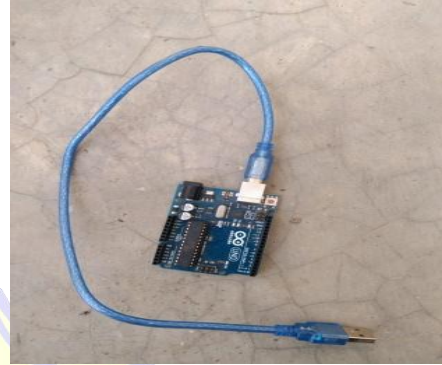
Gambar Arduino Uno dan USB
