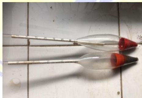
Gambar 3.17 Hidrometer (Sumber: Dokumentasi, 2023)
