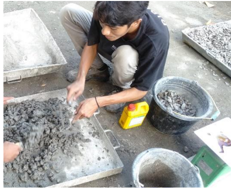
Pengadukan dan pencampuran bahan-bahan sampel beton
