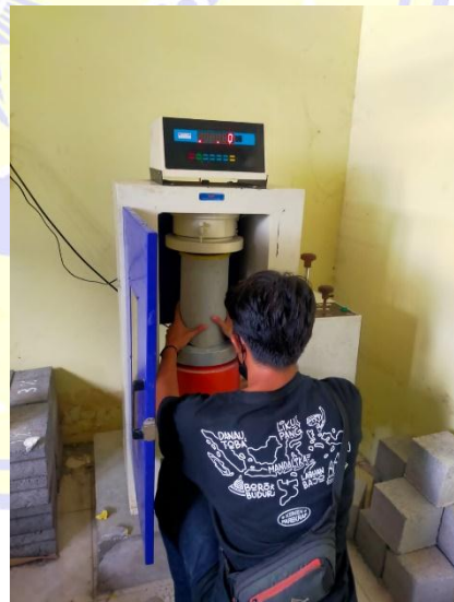
Pengujian kuat tekan beton
