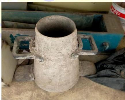
Gambar 3. 15 Kerucut *Abrams*
