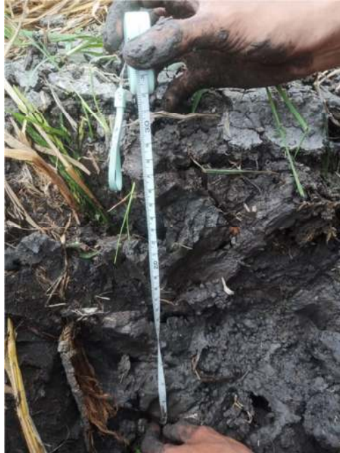
Pengambilan Sampel Tanah dengan Kedalaman 30-50cm
