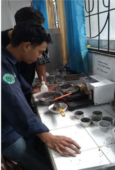
Pengujian Batas Cair Tanah
