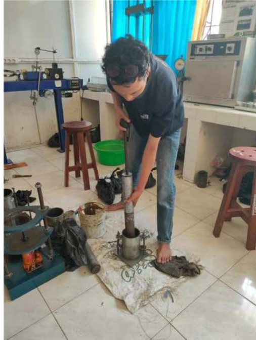
Pengujian Pemaadatan Tanah
