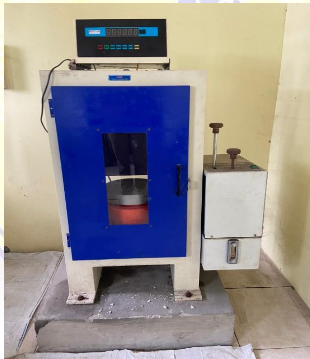
Gambar 3.1 Alat Penguji Kuat Tekan
