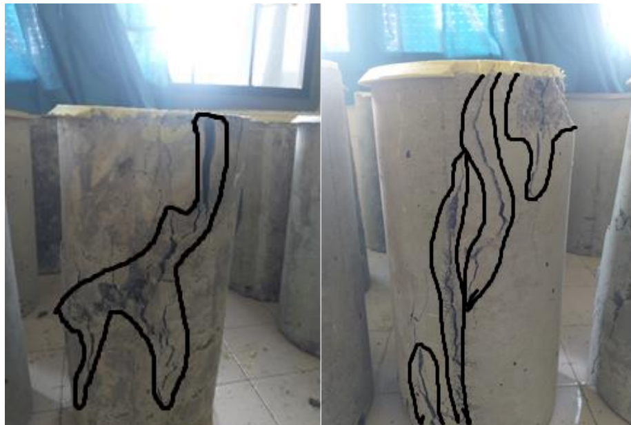
1 Gambar 4.6 Pengujian Kuat Tekan Beton Silinder
