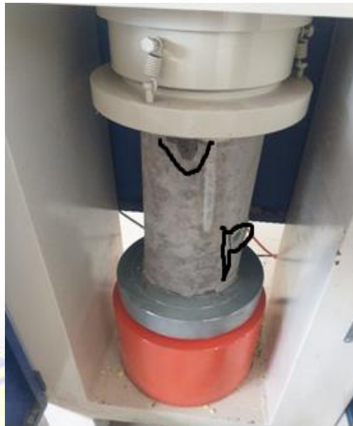
Gambar 4.3 Beton dengan variasi FAS 0,4
