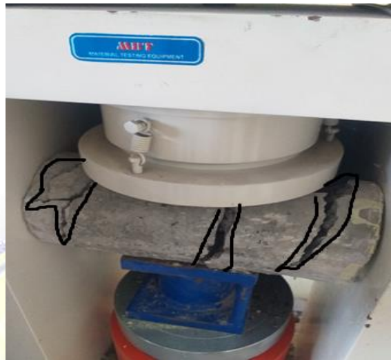
1 Gambar 4.8 Pengujian Kuat Tarik Belah Beton Silinder
