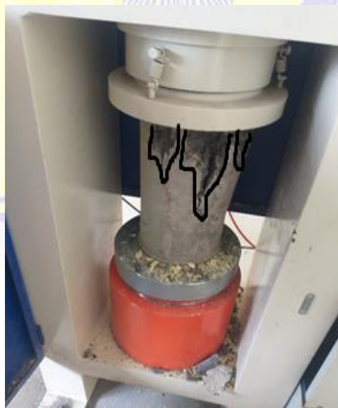
Gambar 4.4 Beton jika variasi FAS 0,5
