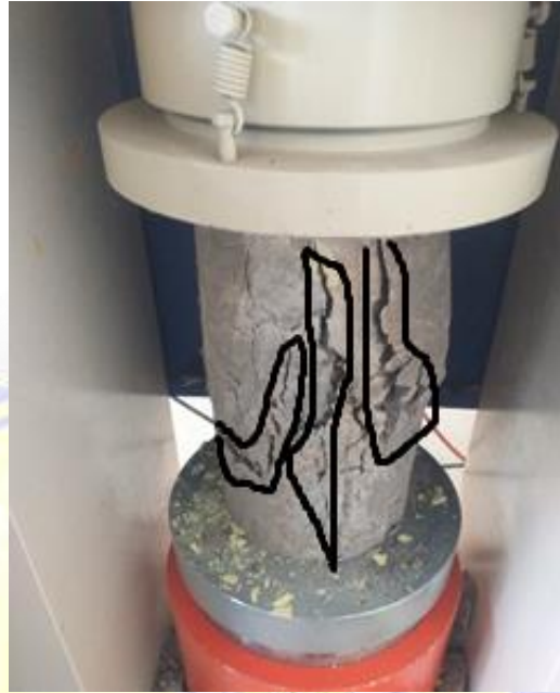
Gambar 4.5 Beton dengan variasi FAS 0,6
