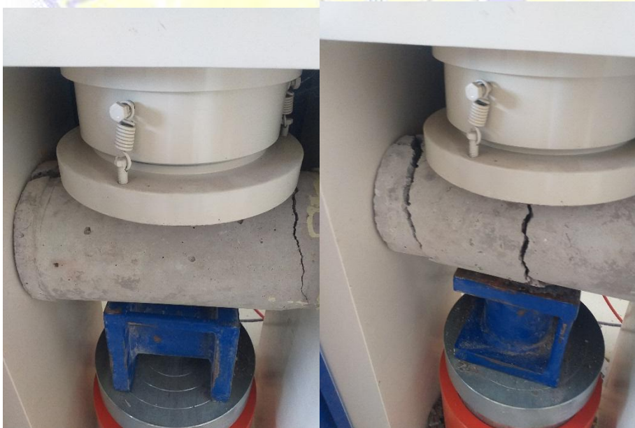
Gambar pengujian kuat tarik belah beton
