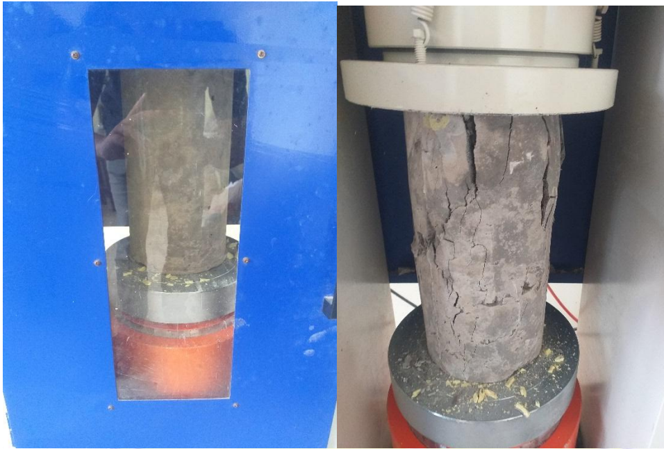
Gambar pengujian kuat tekan beton
