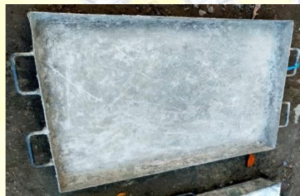
Gambar 3.8. Wadah pencampur beton
