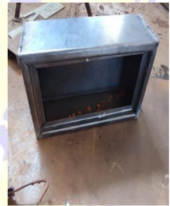
Perakitan box panel
