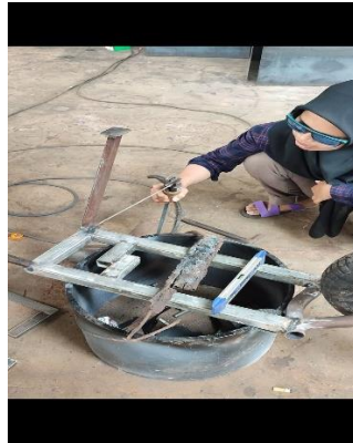
Proses pengelasan kaki rangka
