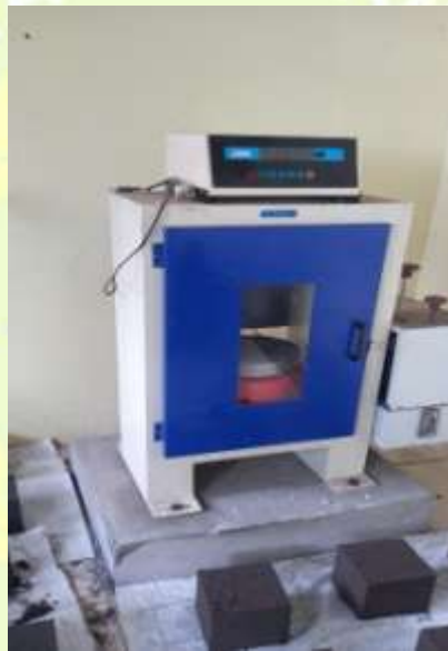
Gambar 3.1 Setting up alat uji kuat tekan (Sumber : Dokumentasi Pribadi, 2023)
