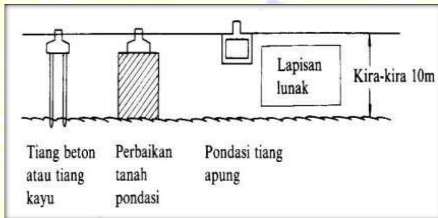
Gambar 2.4 Contoh pondasi jika lapisan pendukung pondasi berada sekitar 10 meter dibawah permukaan tanah (Sumber: Sosrodarsono dan Nakazawa, 2000).
