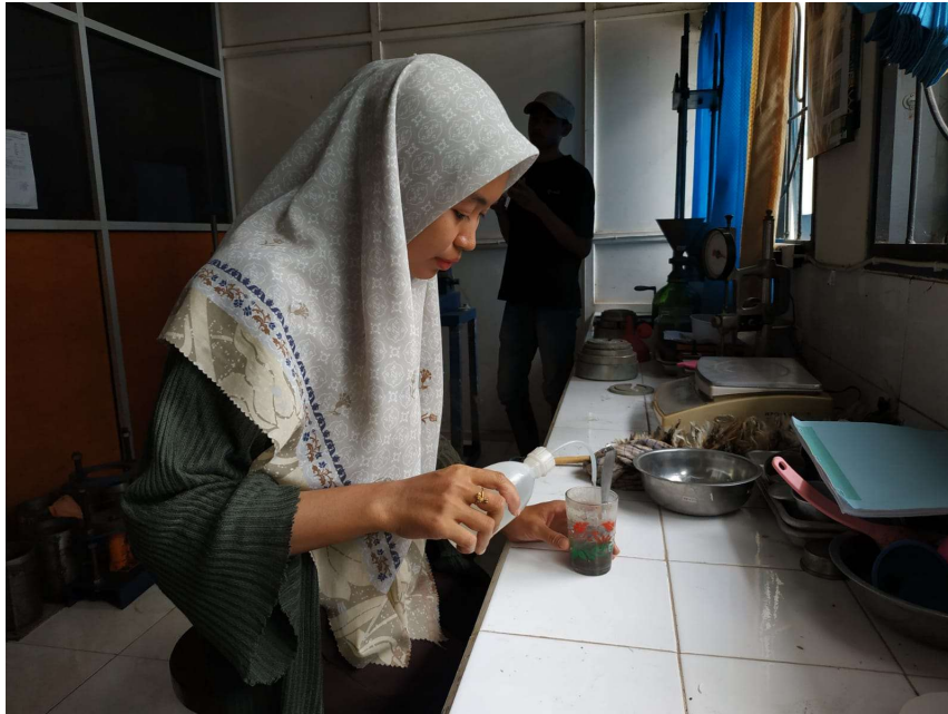
Persiapan Tanah untuk Uji Hidrometer
