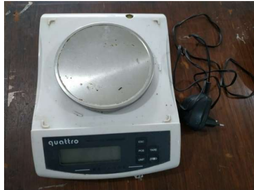
Gambar 3.12 Timbangan Ketelitian 0,01 Gram
