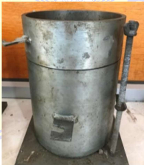
Gambar 3.27 Alat Cetakan CBR
