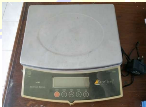
Gambar 3.11 Timbangan Ketelitian 0,1 Gram
