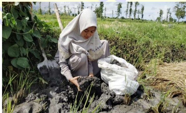
Gambar 3.35 Pengambilan Sampel Tanah Lempung
