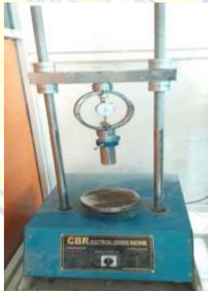
Gambar 3.16 Alat penguji penetrasi CBR laboratorium
