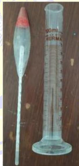
Gambar 3.14 Hidrometer dan Tabung Ukur
