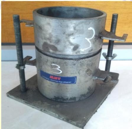
**Gambar 3.8** Alat cetakan uji pepadatan standar proctor
