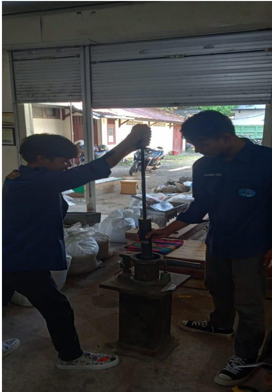
Gambar 3. Pemadatan Benda Uji
