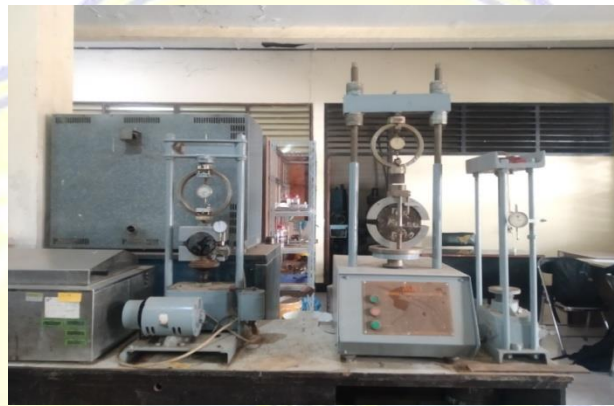
Gambar 3.11 Satu Set Uji Alat Marshall (Sumber: Dokumentasi Pribadi, 2023)
