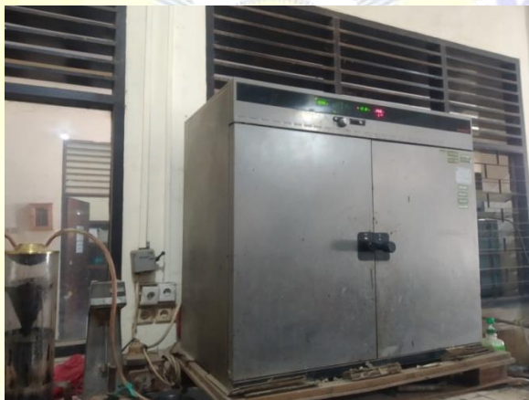
Gambar 3.4 Oven atau Pemanas Agregat (Sumber: Dokumentasi Pribadi, 2023)
