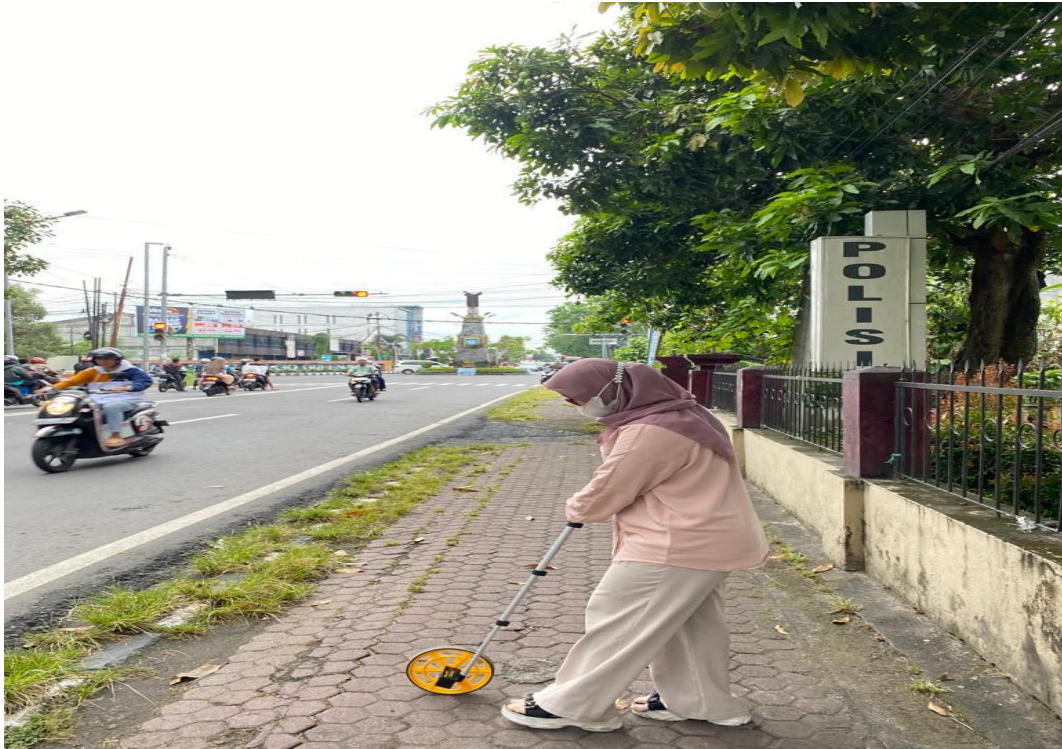
Foto Dokumentasi 1. Mengukur Lebar kerb Jalan Sweta Kota Mataram pada jam 16.00 WITA
