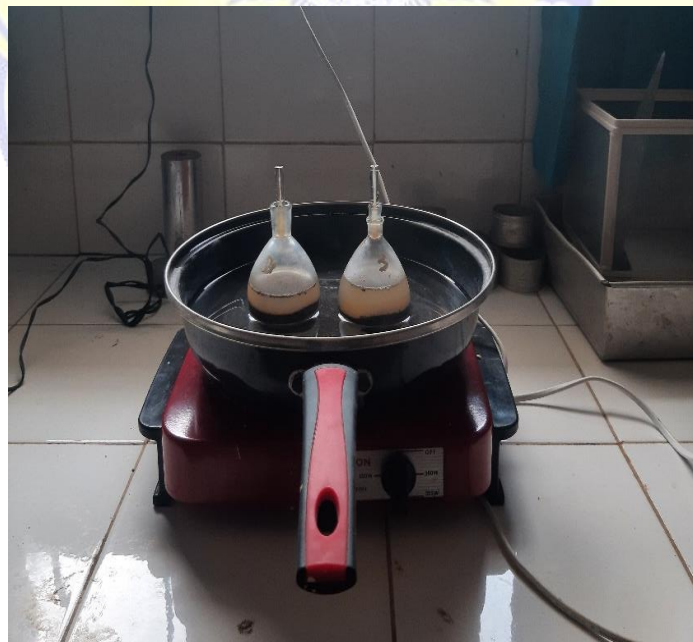
Proses menghilangkan gelembung udara dalam tanah pada pengujian berat jenis
