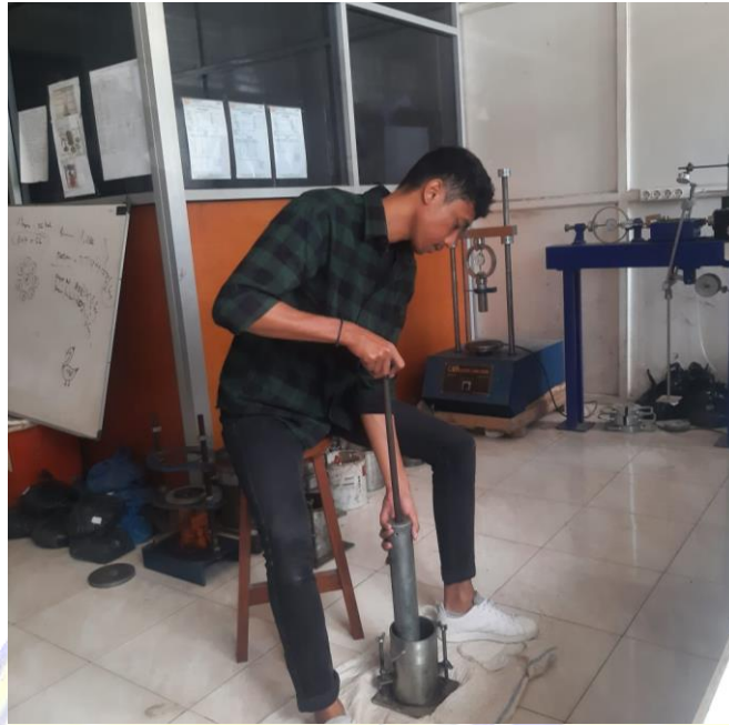
Proses pengujian pemadatan tanah
