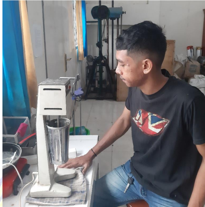
Proses mixer tanah untuk pengujian hidrometer
