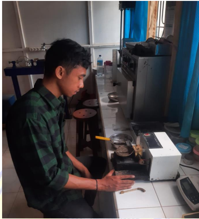
Pengujian batas cair menggunakan alat cassagrande
