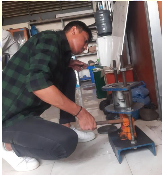
Proses pengeluaran tanah menggunakan alat hidrolis
