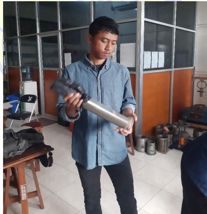
Proses mengkocok tanah dalam tabung setelah dilakukan proses mixer sebelum mulai pengujian hidrometer
