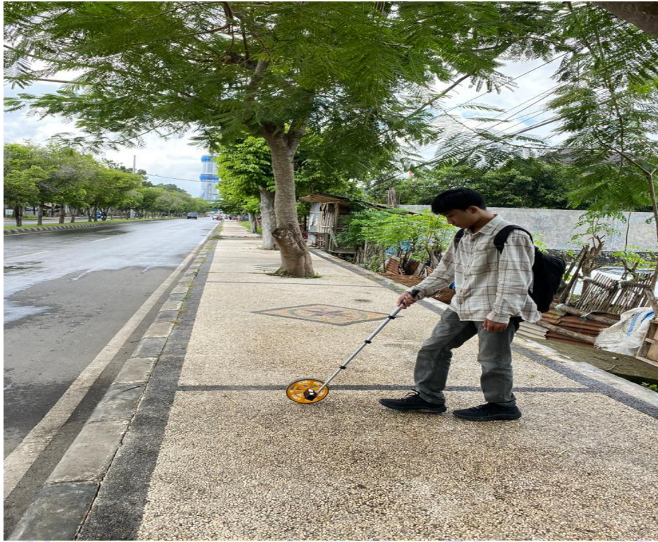
Foto Dokumentasi 3. Pengukuran Lebar Kerb Jalan Dr.Soedjono
