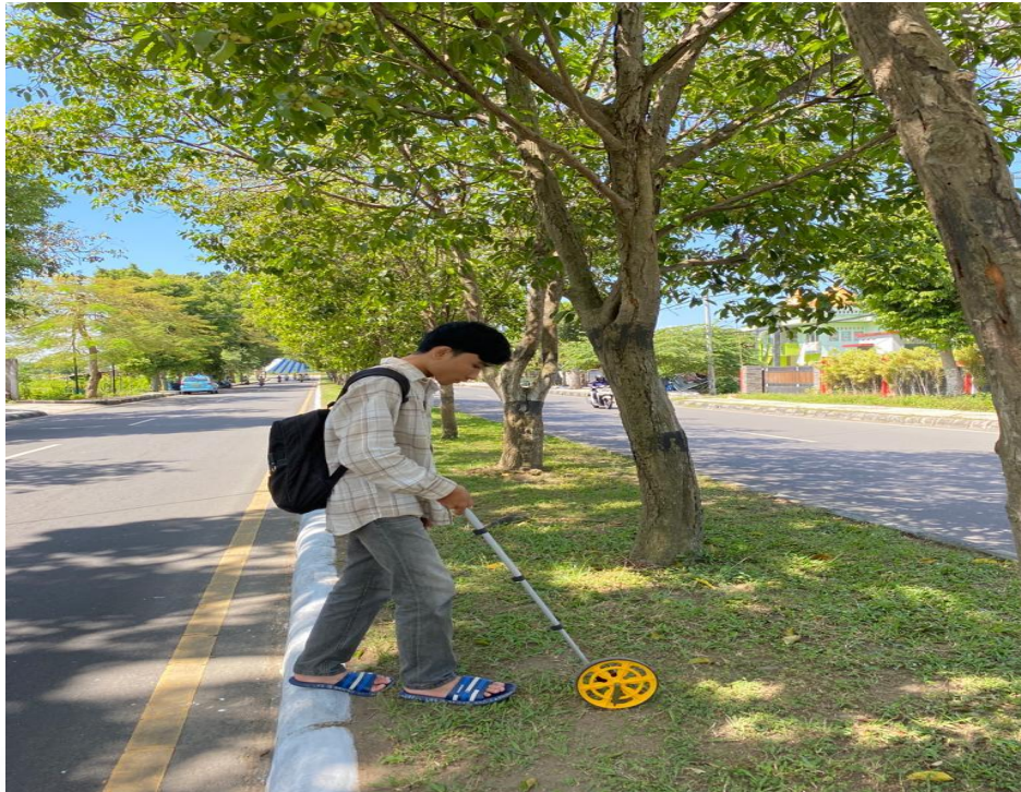
Foto Dokumentasi 5. Pengukuran Lebar median Jalan Dr.Soedjono
