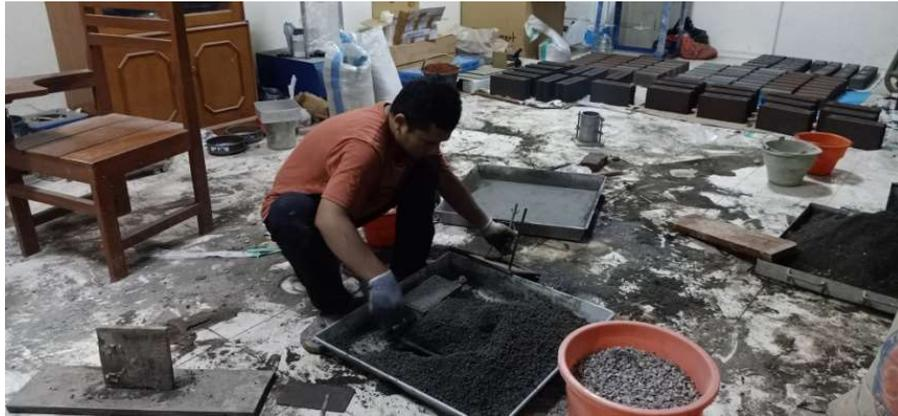
**Gambar 3.1.** Pembuatan Benda Uji *Paving Block*
