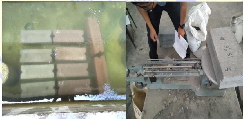
Gambar, 3.8. Pengujian Daya Serap Air (Sumber: Data Hasil Penelitian)
