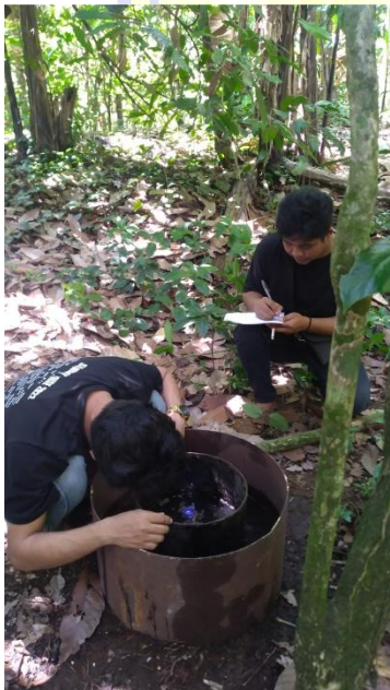
Gambar 5. Pengukuran Penurunan Air Pada Titik 2.
