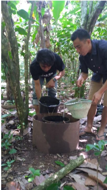
Gambar 4. Pengisian Air Pada Double Ring Titik 1.
