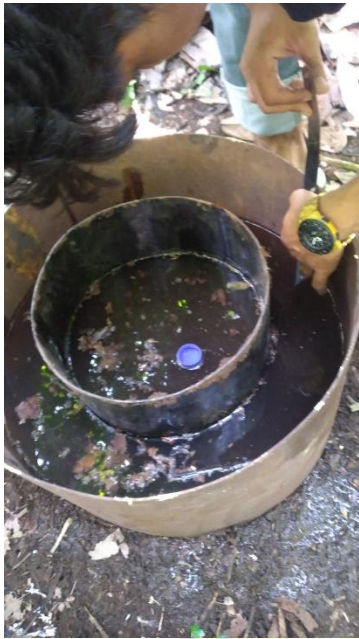
Gambar 6. Pengukuran Penurunan Air Pada Titik 3.
