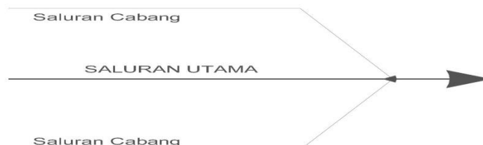
Gambar 2.3 jaringan drainase pola paralel
