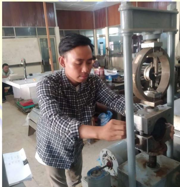
Pengujian Marshall pada benda uji
