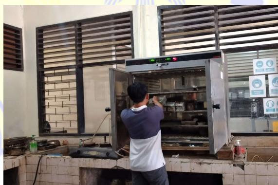
Memasukkan agregat campuran ke dalam oven
