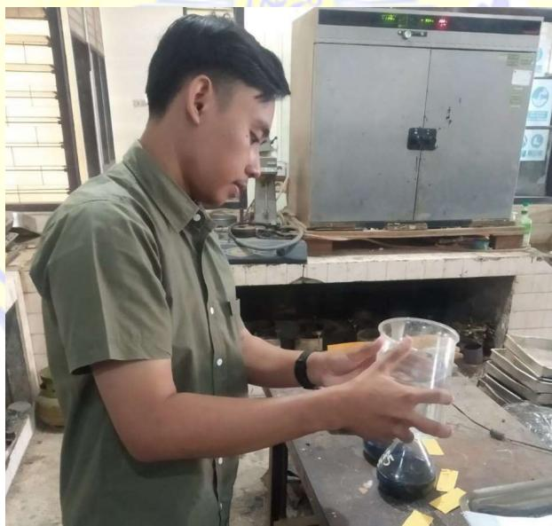
Pengujian BJ Agregat pasir besi dan batu karang
