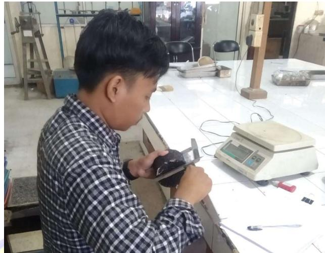
Pengukuran tebal benda uji pada setiap sisi
