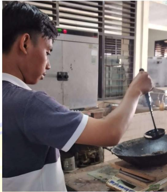
Pencampuran agregat dengan aspal
