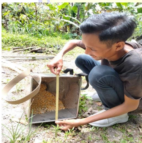
Pengukuran Panjang Hopper
