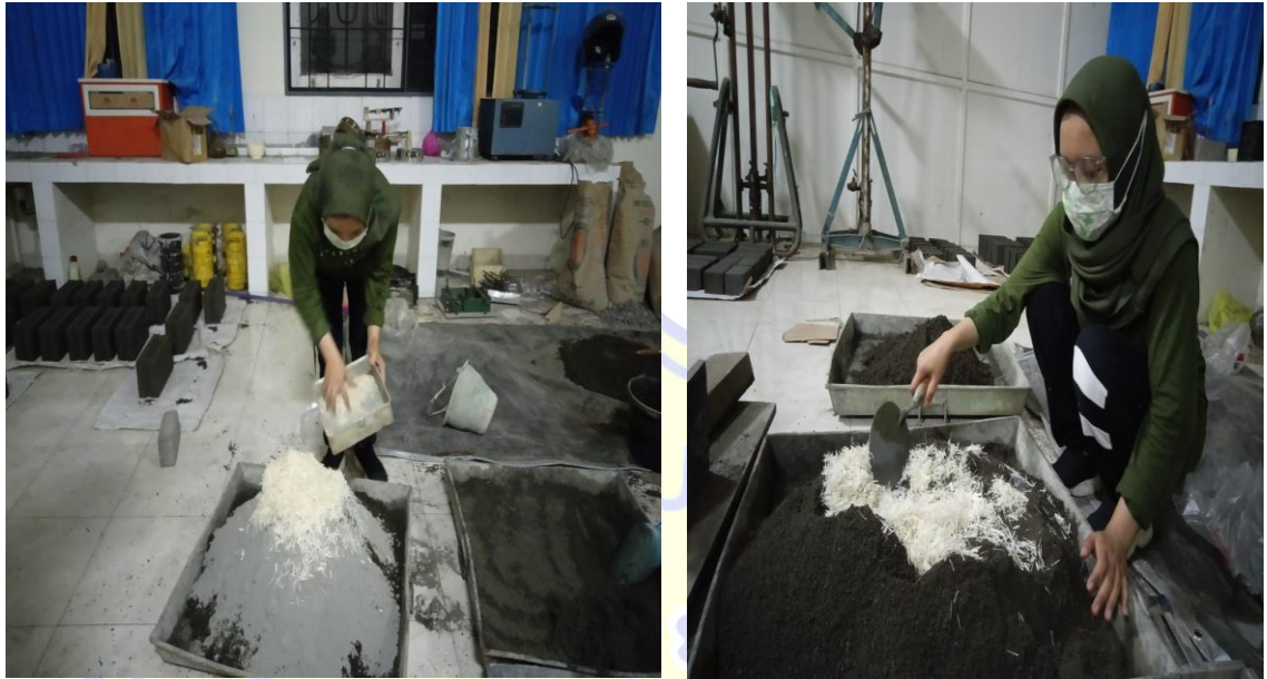
Gambar 15. Proses Pencampuran Bahan Penyusun Batako dengan Serat Tebu
