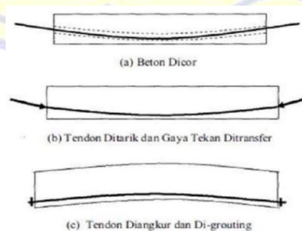
Gambar 2.9 Proses pembuatan beton prategang pratarik (Sumber : Budiadi, 2008)
