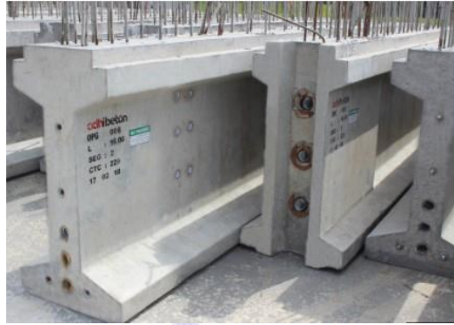
Gambar 2.1 PC I Girder (Sumber: ibb.jatimprov.go.id , 2022)
