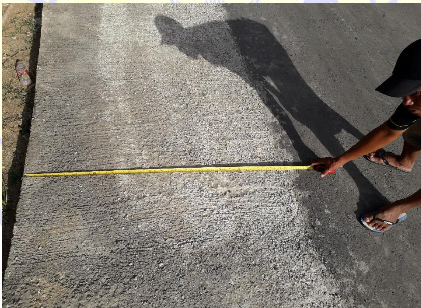
Gambar 9.2. Pengukuran bahu Jalan
